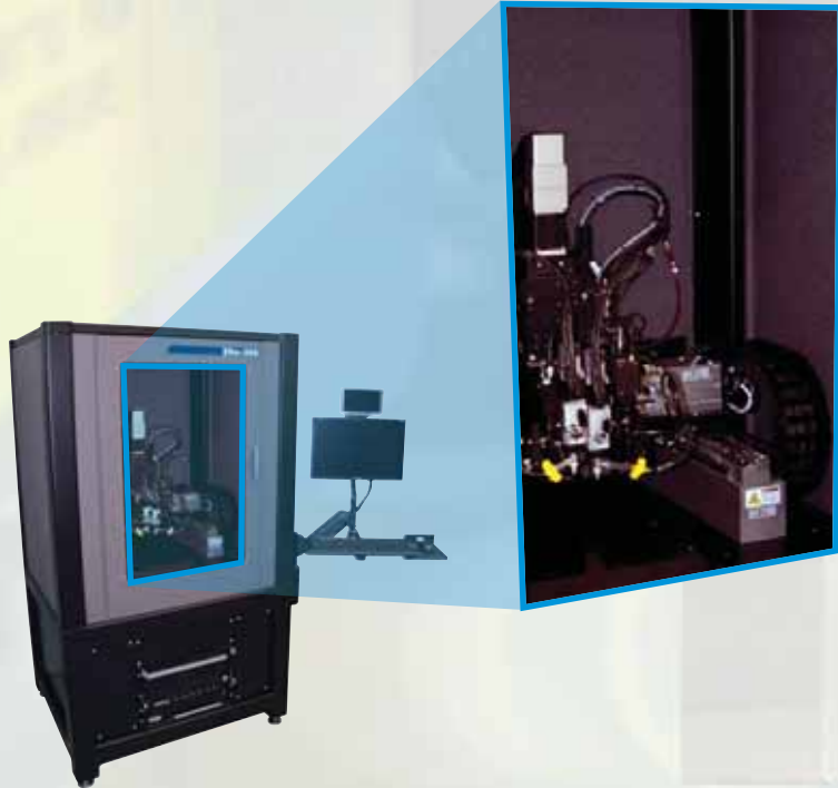
Tissue-Engineering-Systeme der Firma nScrypt stützen sich auf hochpräzise Aerotech-Systeme, die zur Erzeugung komplexer, dreidimensionaler, biologisch kompatibler Gewebegerüste eingesetzt werden. (Bildnachweis: nScrypt Inc., Orlando, Florida)
