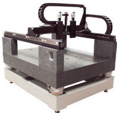
Flachbildschirm-Prüfstation in Portalbauweise mit einem Verfahrweg von 1800 x 800 x 200 mm.
