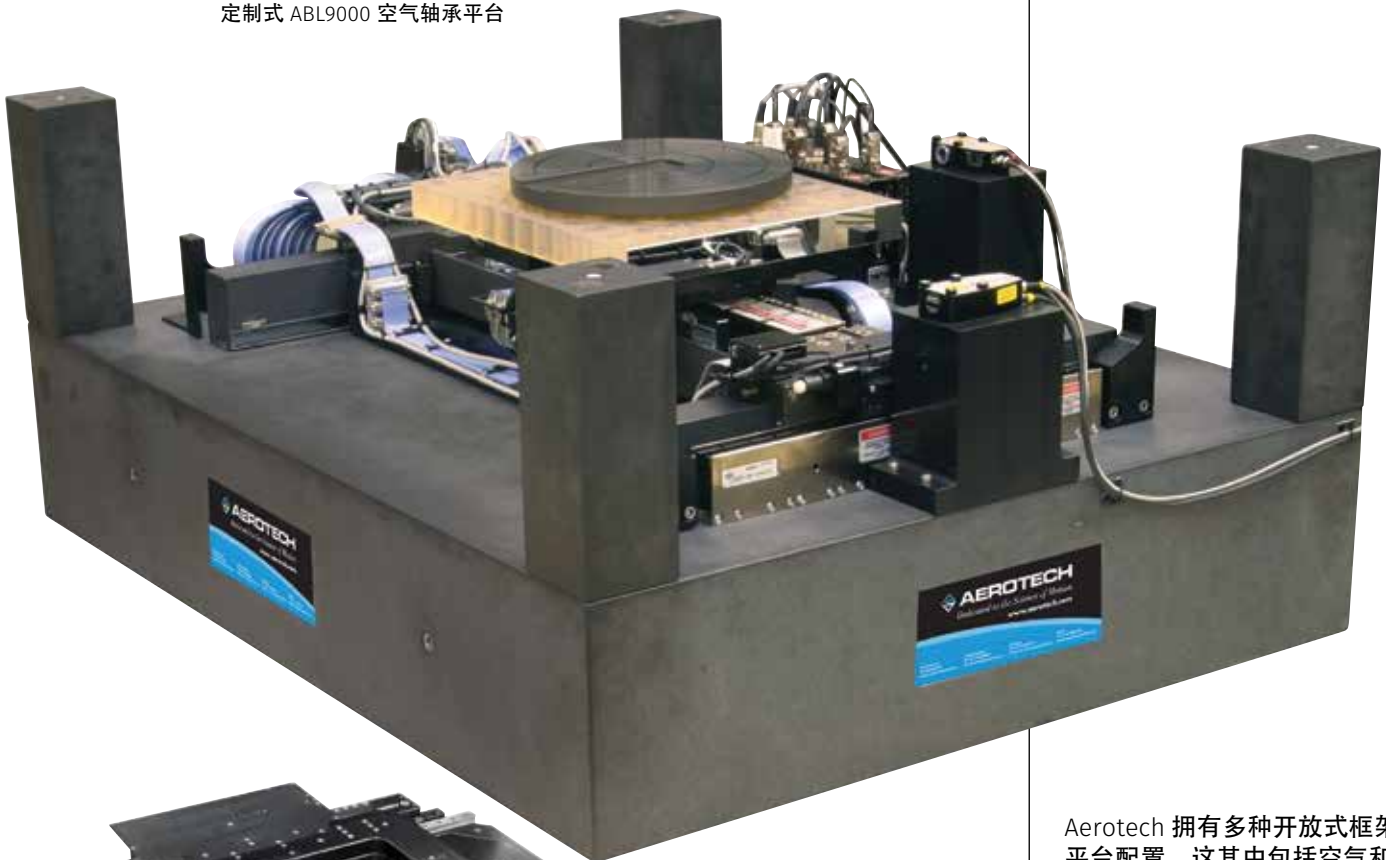
带有二轴激光干涉仪反馈装置的定制式 ABL9000 空气轴承平台
