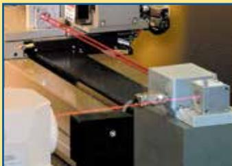
超高分解能とフィードバック安定性を必要とするシステムでは、干渉計フィードバックを使用します。
