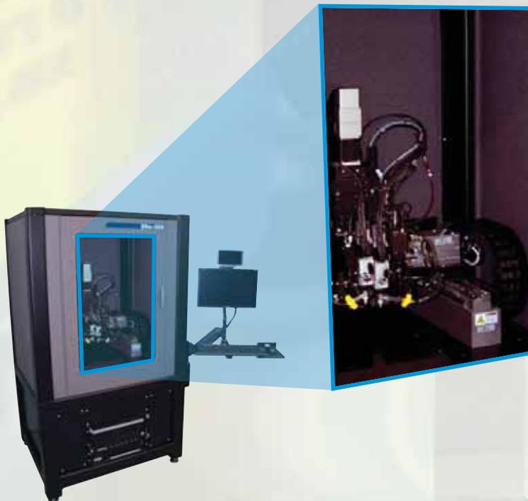
来自 nScript 的组织工程工具依赖于精密的 Aerotech 平台和控制系统，并结合专利分配技术，从而形成复杂的三维生物兼容工作台。
