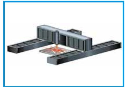
将复杂的台架控制简化为几个简单的命令, 以处理双电机和/或双反馈配置
