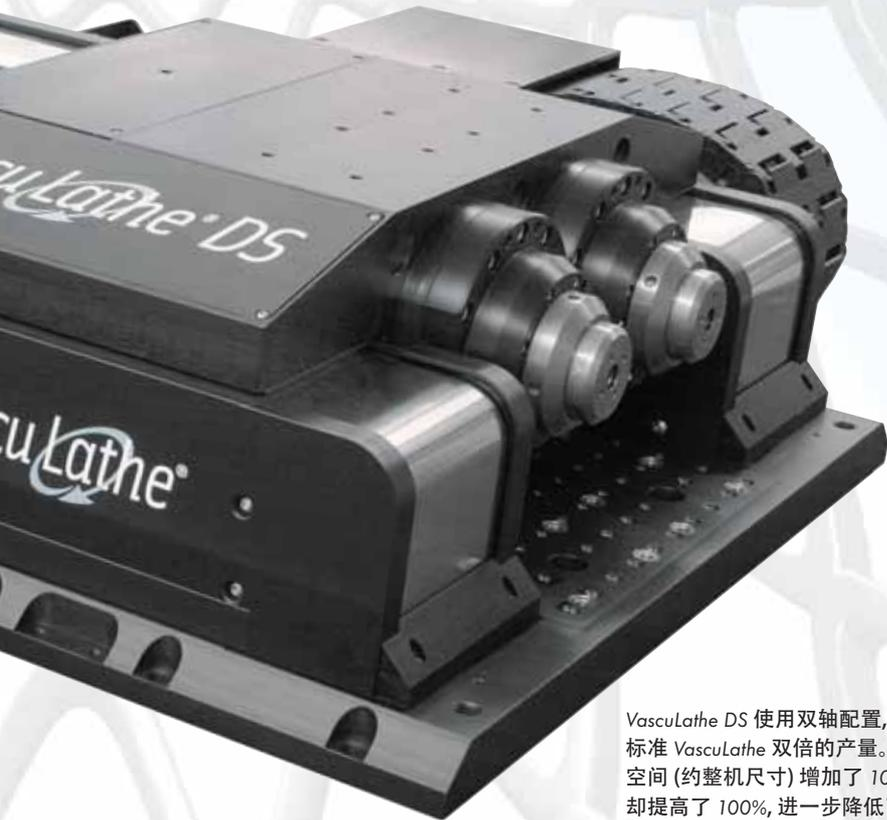
VascuLathe 配备 Aerotech 的 100% 数字自动化平台—Automation 3200 控制器 (A3200) A3200 的先进控制架构具有特殊的路径规划功能,可自动调整切割速度以最大程度减小密封支架几何形状的路劲误差,保持整个部件的形质。先进的激光控制功能可自动调整激光功率和重复率,以最大程度缩小随切割速度而变化的材料受热区域。针对在典型支架外形中遇到的频繁换向,我们优化了专门的驱动电路,有助于进一步减小跟踪误差。先进的测绘和诊断工具实时显示轴性能,而流程监控功能则可报告位置误差峰值,路劲切割长度,以及各部件完成时的支架切割时间。这些工具与功能提供了一种逐件地即时测量部件质量的方法。
